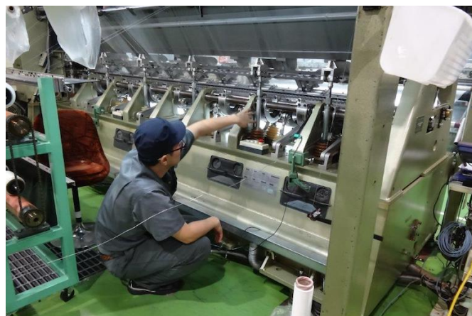
針金を使ってAEセンサーを編機に繋ぐ
