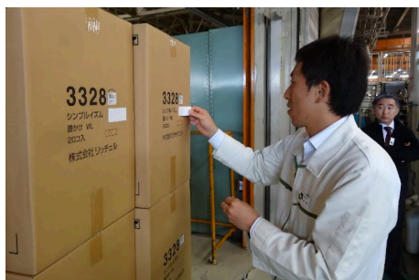
完成品の外装にRFIDタグを貼る様子。将来的には商品一つひとつに貼ることを目標としている
